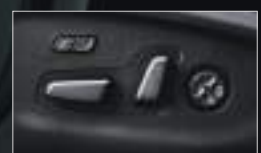
Блок регулировки водительского кресла в 14 направлениях, включая поясничный подпор
