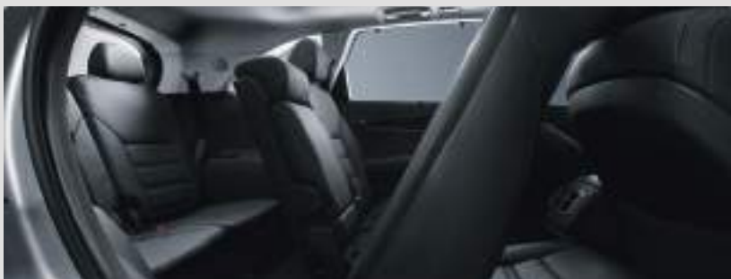
Удобная высадка и посадка В 7-местной версии модели второй ряд сидений складывается и сдвигается вперед на 270 мм, обеспечивая удобство доступа к третьему ряду кресел.
