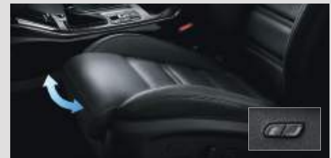
Увеличение длины подушки кресла водителя В новом KIA Sorento Prime не забыты и высокие водители. Одним нажатием кнопки можно увеличить длину подушки сиденья водителя, создав дополнительный комфорт.
